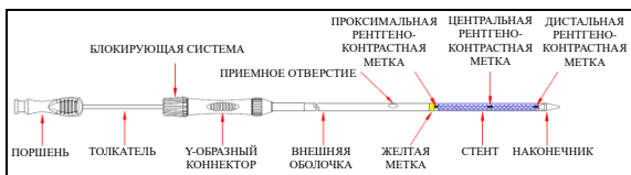
Рис. 3: Система интродуктора (коротким проводником)
