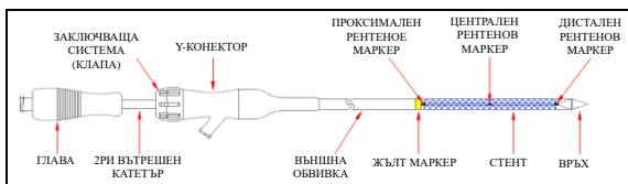
Фигура 2. Въвеждаща система (Дистално освобождаване & Проксимално освобождаване)
