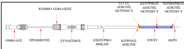
Εικόνα 3. Σύστημα εισαγωγέα (Εισαγωγέας TTS)
