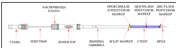
Фигура 2. Въвеждаща система (Перкутанна и Ендоскопска)
