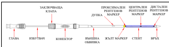
Фигура 3. Въвеждаща система (Къс водач)
